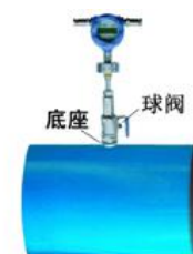
插入式管道安装示意图
